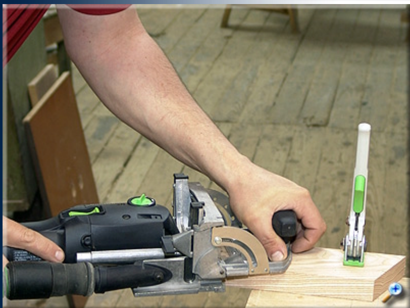
В брусках со скошенных под углом 22,5° градусов торцами фрезеруются отверстия под вставные шипы «Domino».
