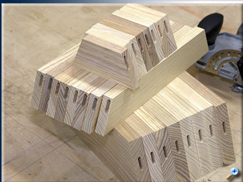
Пазы под шипы расположены на брусках с учетом будущего профиля.
